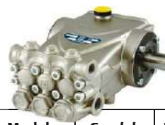
SERIE C2W ALTA TEMPERATURA (242x215x122mm | 7Kg | eje Ø24mm | SAE 15W40)
