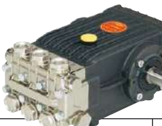
SERIE 47HT ALTA TEMPERATURA (315x254x146mm | 14,5Kg | eje Ø24mm | SAE 15W40)
